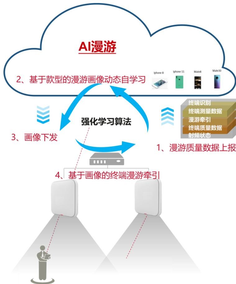
终端使用 AI 漫游引导速率提升 70%，整网的终端平均 RSSI 相较普通漫游提升 5dB 以上，漫游过程中带宽提升 30%，达到无缝漫游、无感切换效果。
